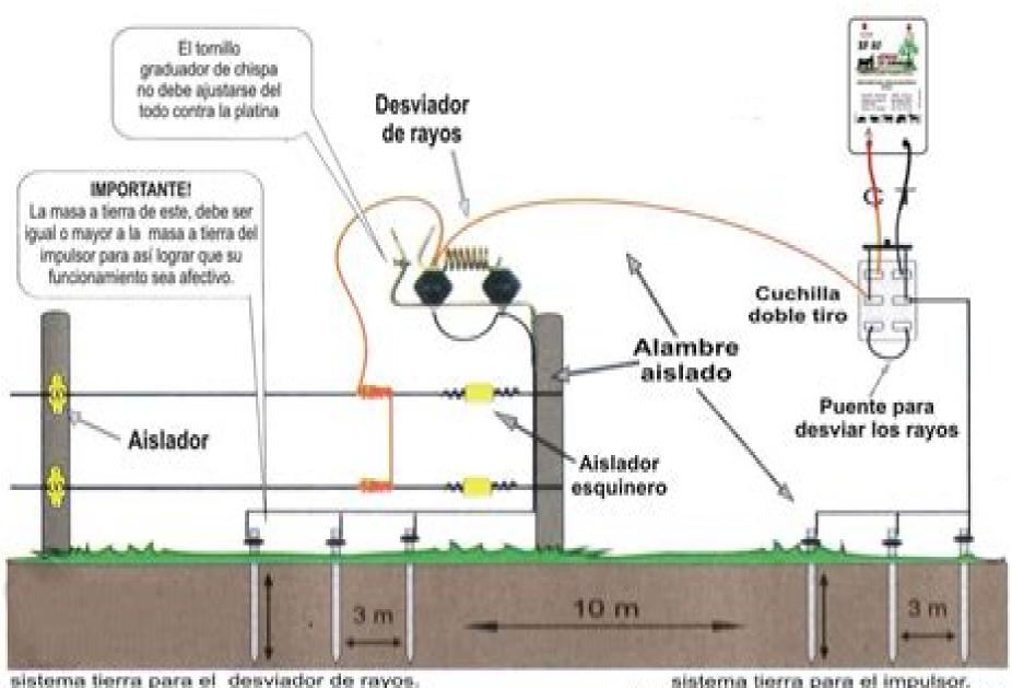
sistema tierra para el desviador de rayos. varillas de coperwelld con abrasadera sistema tierra para el impulsor. varillas de copperwalld con abrazadora
