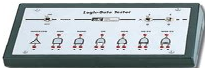
Figure 602 : Vous vous rendrez vite compte de l'utilité de cette table de vérité électronique, car elle vous permettra de savoir instantanément quel niveau logique sera présent sur la sortie d'une porte, simplement en modifiant les niveaux logiques sur les entrées.
