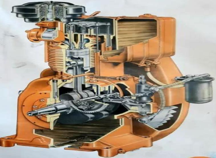
motore diesel raffreddato ad aria della serie
