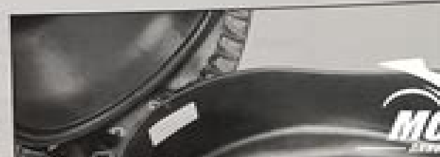
2) Il numero di serie del motore è stampigliato sulla parte posteriore del carter sinistro
