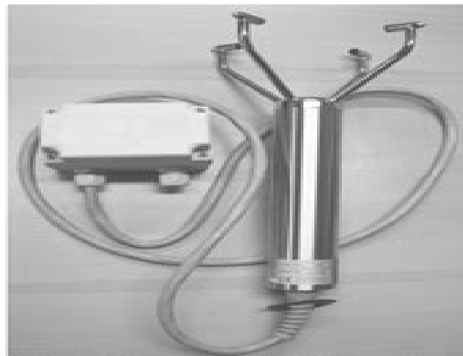
Sensor de viento con cable y caja de conexiones
