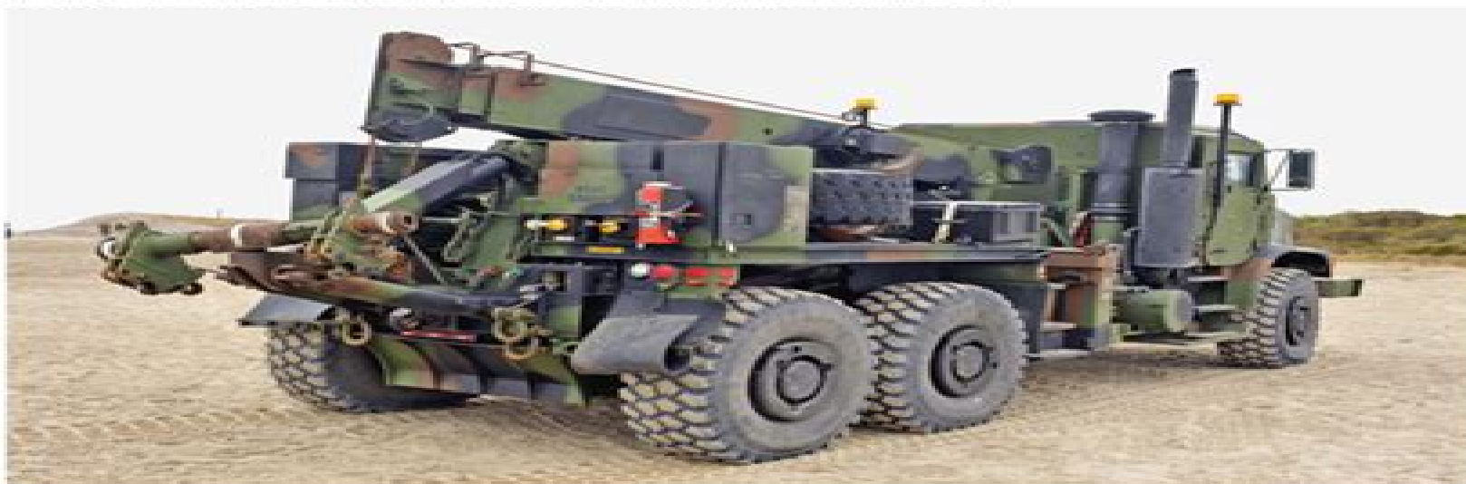
Der Einsatz der Hauptwinde der MX-30, MX-30A1 und AMX-30 Bergeladefahrzeuge erfolgt über das Fahrzeugheck. Die Hauptwinde von der Manufacturer besteht aus zwei Trommelwinden, die je eine Zugkraft von 15,876 kg haben. Die Ausladung der 36 mm dicken Winderwinde beträgt 97,5 m. The main winch of MX-30, MX-30A1 and AMX-30 Wreckers operates over the rear of the vehicle. Made by the Manufacturer, the winch system incorporates two drum winches, each with a maximum pulling capacity of 15,876kg. The winch cables are each 97,5m long and 36mm thick. (Carl Schuler)
